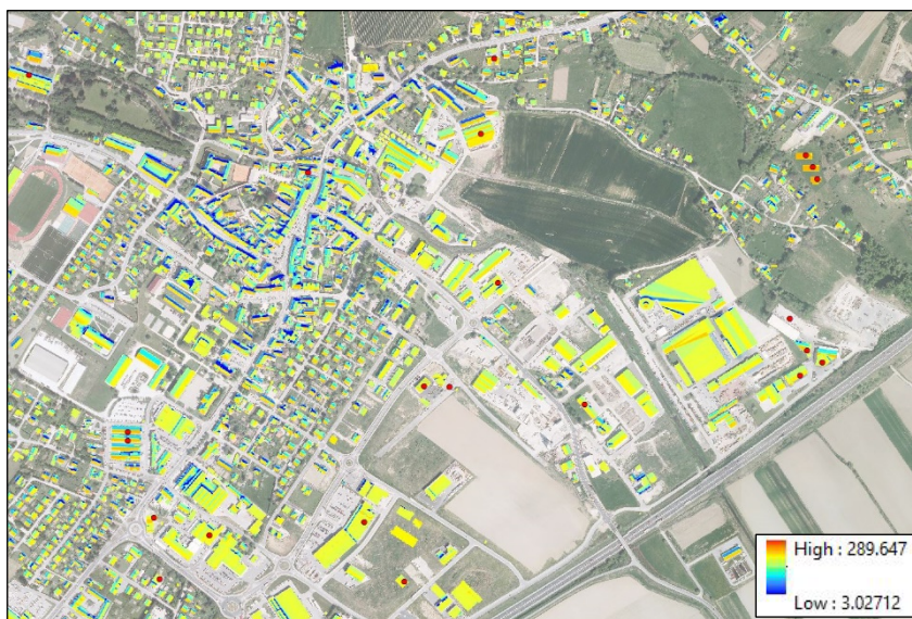
Slika 11: Solarni potencial (kWh) po Standard Sky modelu v naselju Slovenska Bistrica. Vir podlage: GURS 2019.
