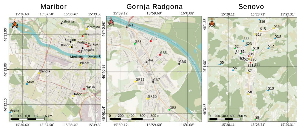
Slika 3: Slika 3: Merilna mesta v Mariboru, Gornji Radgoni in na Senovem. Rdeči simbol označuje nezasečenena svetiila, rumeni zasečenena, črni popolnoma zasečenena. Z modro oznako pa so prikazane lokacije, kjer svetil ni bilo v bližini.
