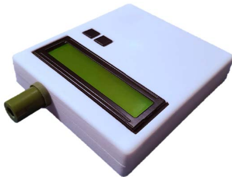
Slika 2: Merilnik Fakultete za strojništvo je izdelan na podlagi mikrokrmilnika Arduino nano in zaznavala TSL237. Vključuje LCD zaslon za prikaz rezultata in odstranljiv pokrov senzorja.
